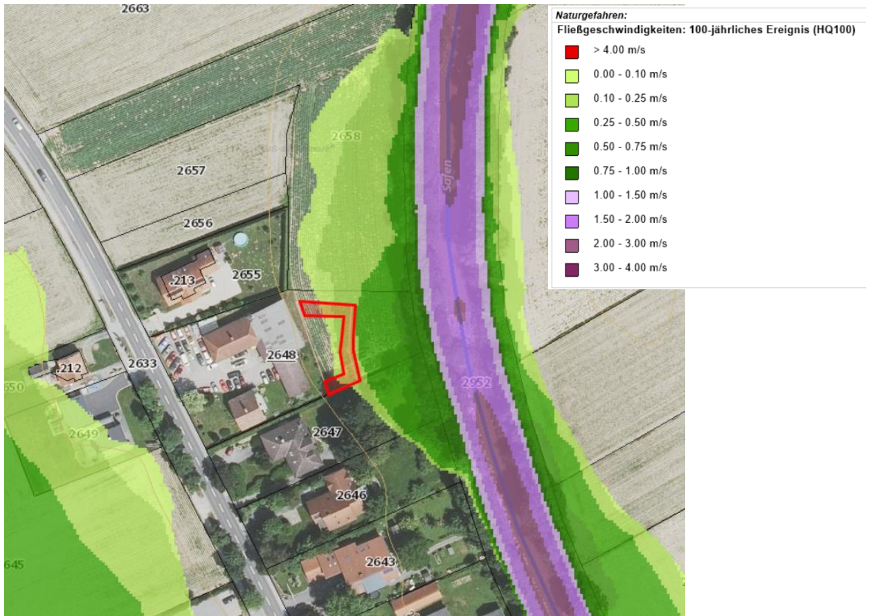
Abbildung 4: Fließgeschwindigkeiten HQ100 (GIS, ABU Safen)
