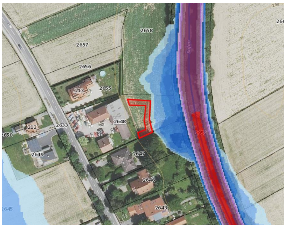
Abbildung 2: Wassertiefen HQ 30 (GIS, ABU Safen)
